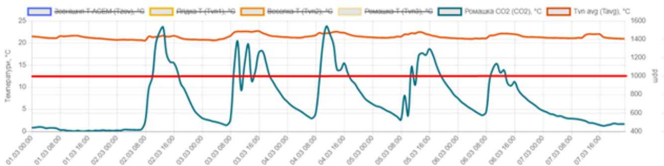
Рис. 6 Контроль параметрів мікроклімату в громадській будівлі
