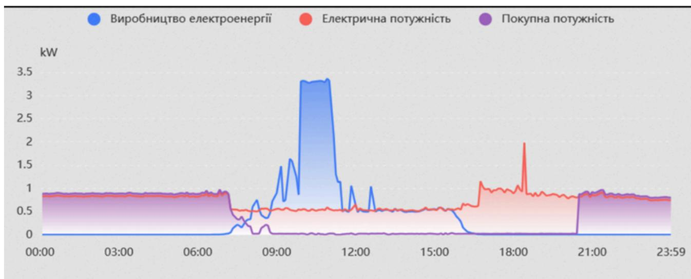
**Рис. 8 Добовий графік роботи гібридної сонячної електростанції (літній режим).**
