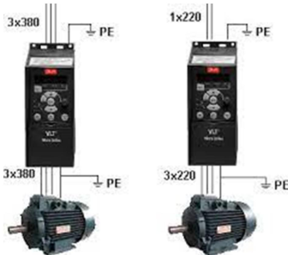
Рис. 3 Підключення насосного обладнання через частотні регулятори
