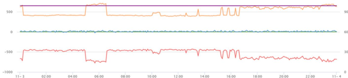
**Рис. 6 Профіль навантаження п'ятиповерхового житлового будинку з системою освітлення, безпеки, циркуляційними насосами на опалення та гаряче водопостачання.**
