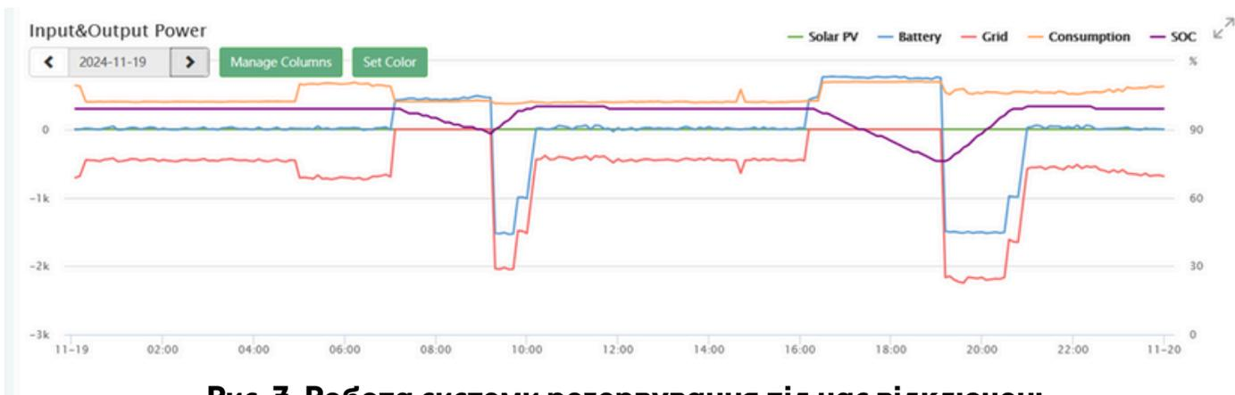
**Рис. 7. Робота системи резервування під час відключень.**
