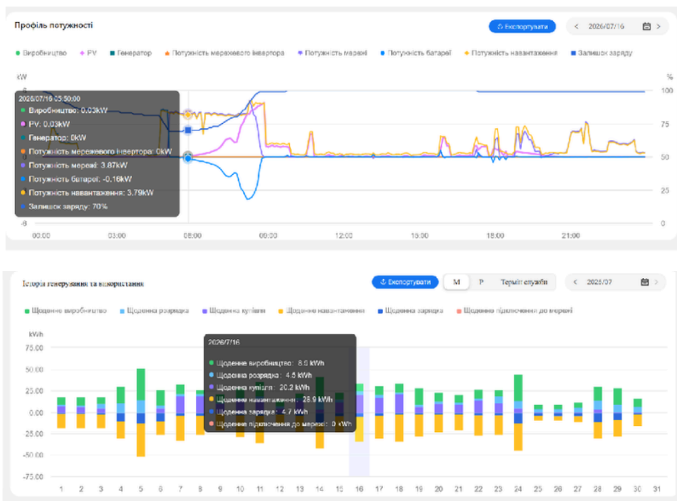
Рис. 17 Приклад неоптимізованого графіку використання сонячної електростанції
