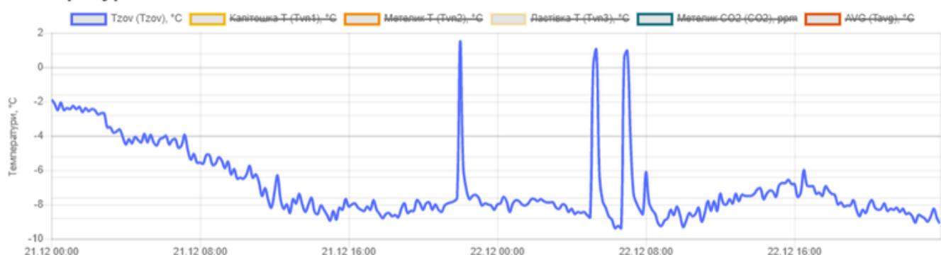
Рис. 11. Приклади аномальних температур, спричинених невірним розміщенням датчиків
