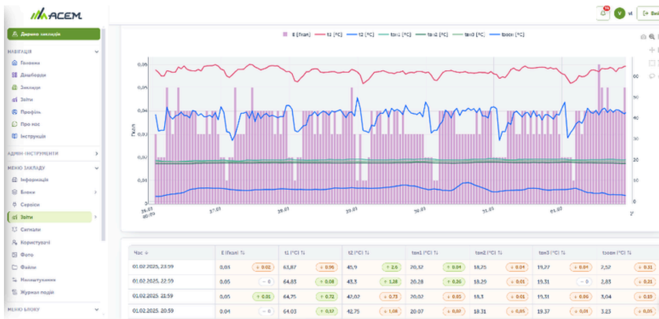
Рис. 10. Дані по споживанню для об'єкту з погодинним регулювання з системи енергомоніторингу
