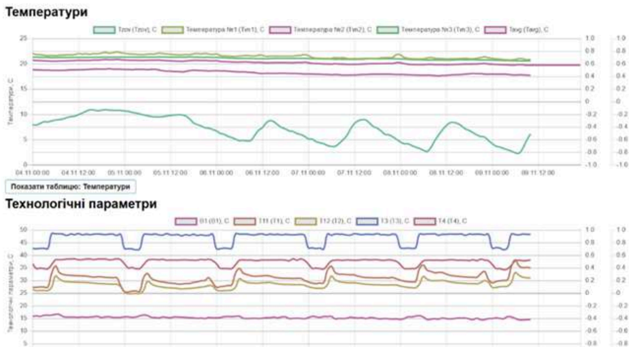
Рисунок 3.2 . Приклад налаштованої системи керування параметрами мікроклімату за допомогою системи енергомоніторингу
